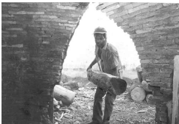
Figura 6 : Carvoeiro enchendo o forno com eucalipto para o processo de carvoejamento – Ribas do Rio Pardo.
